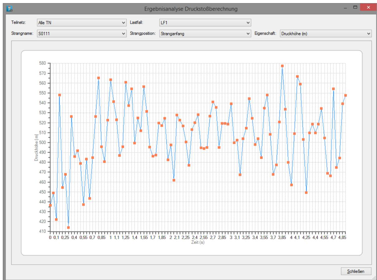
Ergebnisse der Druckstoßberechnung analysieren
