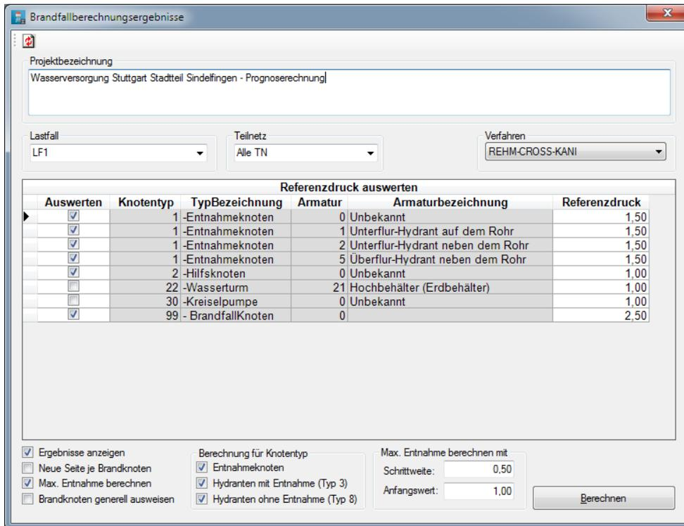
Dialog mit dem die automatische Brandfallberechnung hier max. mögliche Entnahme gestartet wird. Referenzdrücke können u.a. auch hier eingestellt werden.
