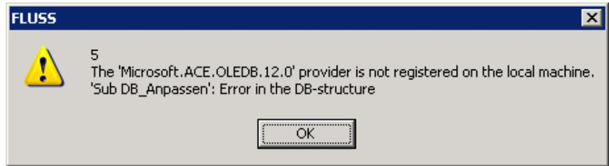
Abb. 1: Fehlermeldung bei falschem Datenbanktreiber in FLUSS
