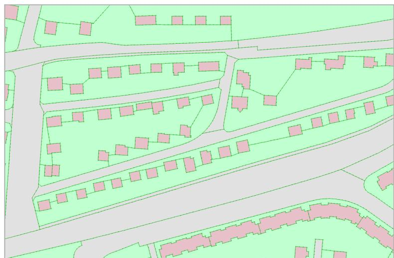
Abb. 3: Fehlerfreie Gebietseinteilung mit automatisch verbundenen Inselpolygonen als Grundlage für die Netzgenerierung
