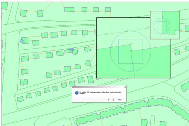
Abb. 2: Funktion „Bereinigen“ mit Erkennung fehlerhafter/ungünstiger Strukturen nach erfolgreicher Inselverbindung
