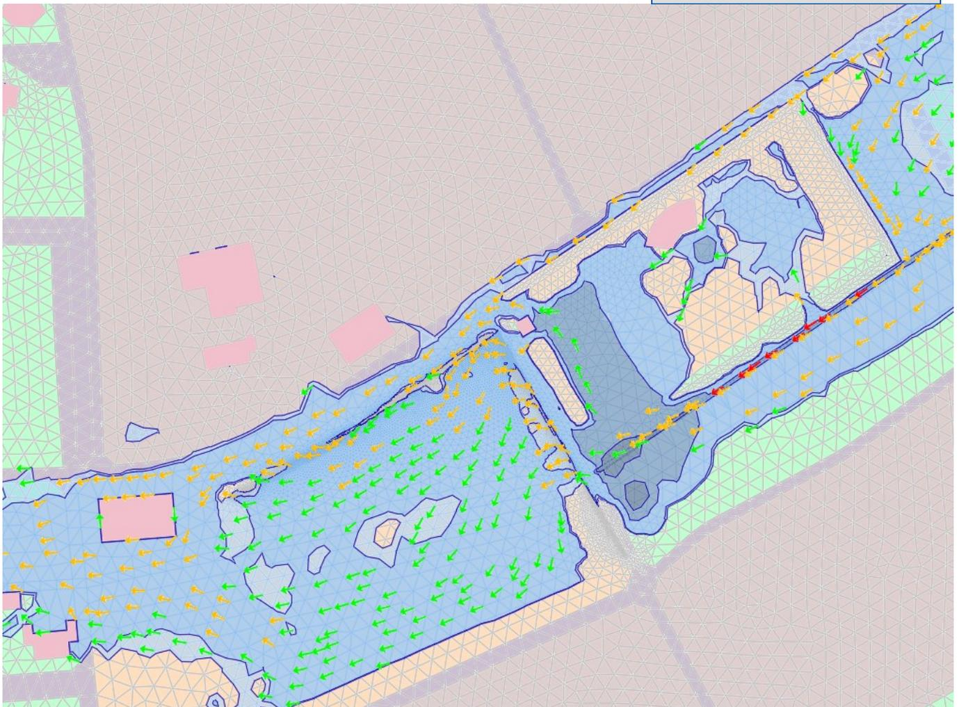
Abb. 1: Ergebnisdarstellung in FLUSS-2D: Option „Starkregen Überflutungstiefen BW“
