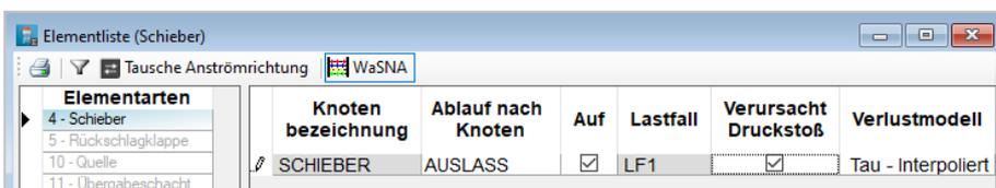
Abb. 3: Druckstoßdefinition eines Schiebers
